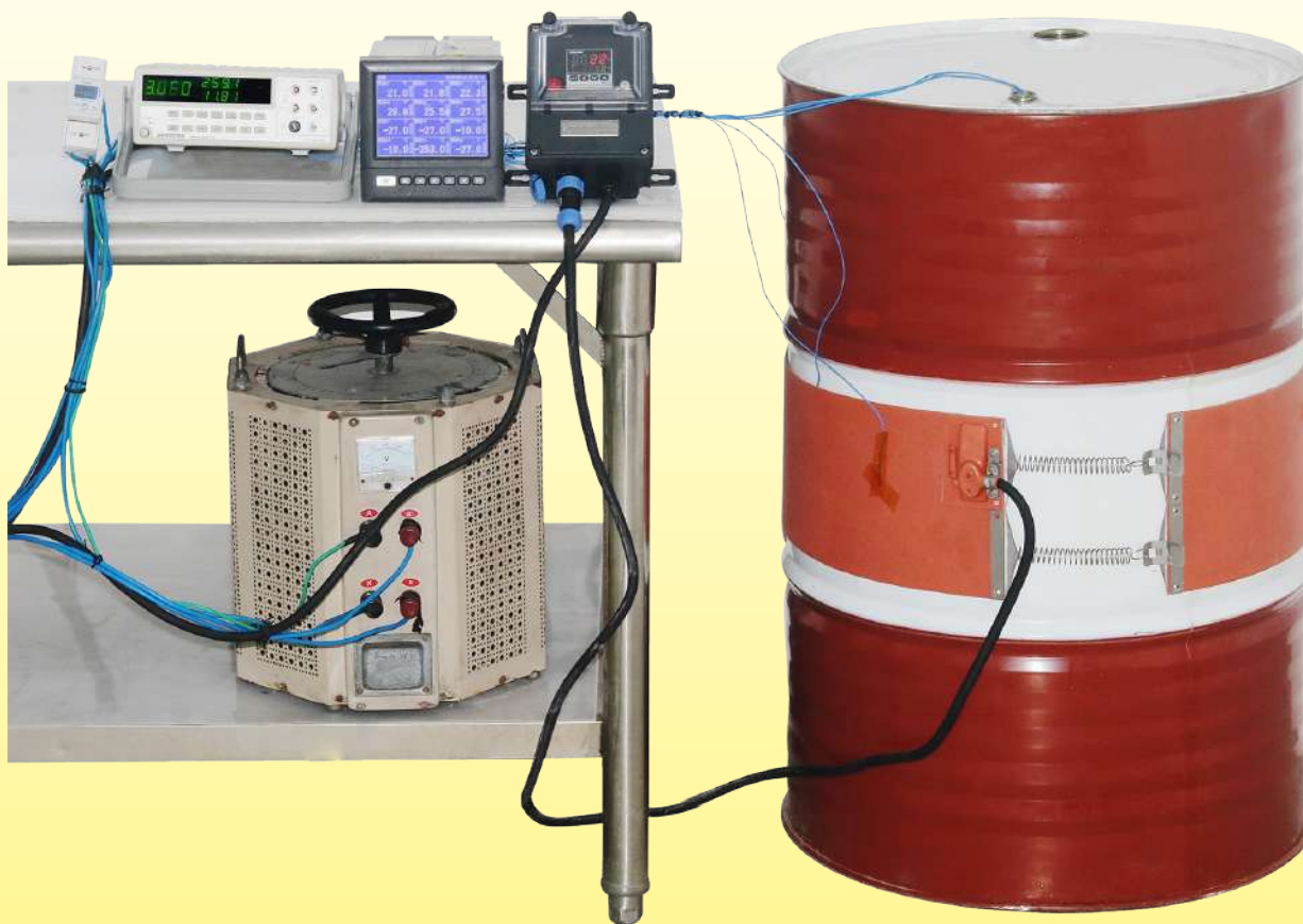
Variazione della temperatura nel tempo di un fusto metallico da 220 litri, riempito d'acqua, riscaldato da un nastro riscaldante in silicone largo 200mm, senza isolamento termico, potenza 1500 W (carico superficiale 0.5 W/cm 2 ).
